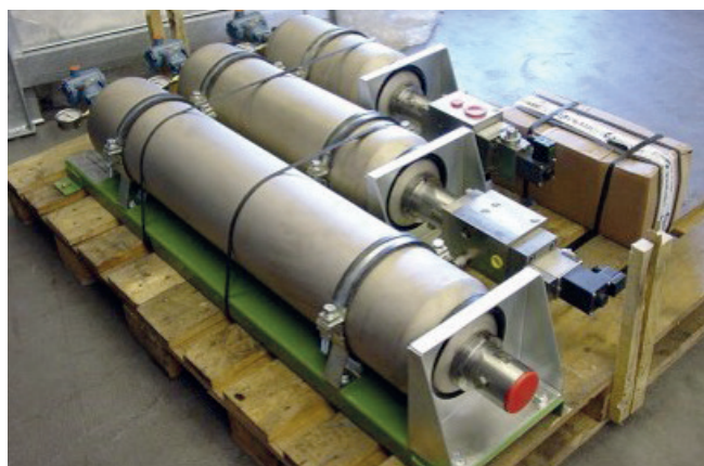
Application: système d'eau NOX Client: Alstom, Baden Produits ORELL utilisés: accumulateurs à vessie avec corps de soupape spécifique
