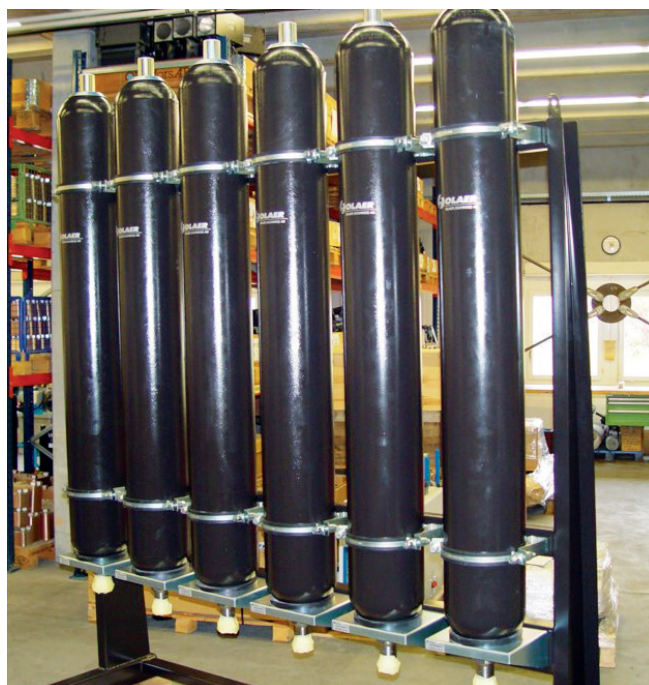
Application: réserve d'énergie Client: Hagenbuch, Ebikon Produits ORELL utilisés: batterie d'accumulateurs à vessie SST 6 x 50 avec approbation ASME
