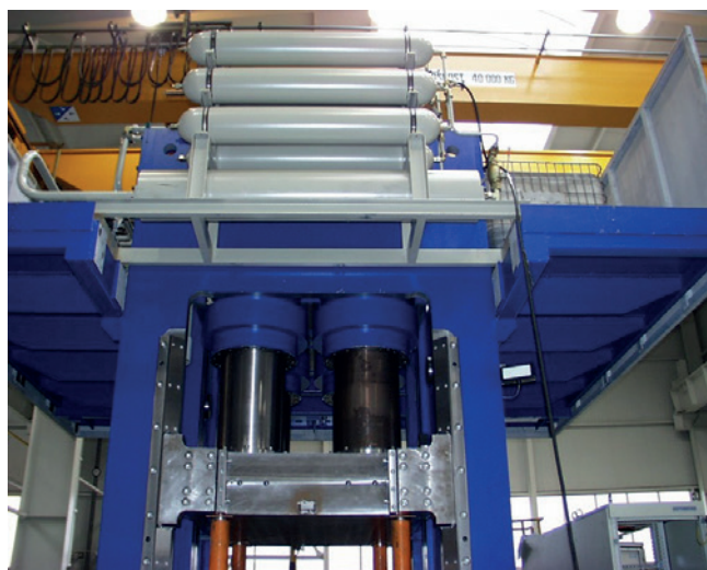
Application: presse hydraulique Client: Bosch Rexroth, CZ Produits ORELL utilisés: accumulateur à pistons avec bouteilles de gaz connectables
