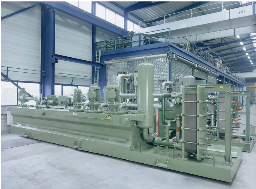
Application: système de lubrification GT 13 Client: Alstom, Baden Produits ORELL utilisés: accumulateurs à vessie EBV 475-8/90
